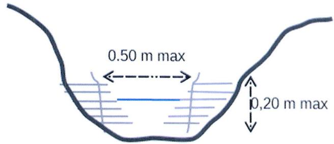
**Le prestataire retenu aura un matériel adapté aux travaux en zone de marais, à savoir une pelle hydraulique à chenille, équipée d'un godet de curage pour fossés. La taille du godet de curage et du bras de la pelle sera adaptée à la typologie du cours d'eau (largeur, profondeur, profil en travers et en long, sinuosité), à la portance du sol et au type d'entretien préconisé.**
